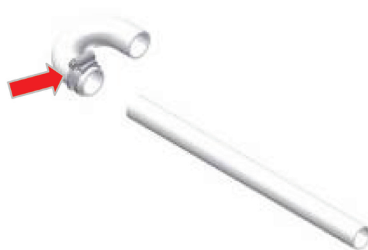
Obr. 16: Montáž hadice na kondenzát ve tvaru U
