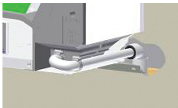
Obr. 17: Připojení trubky 22 mm na odpad
