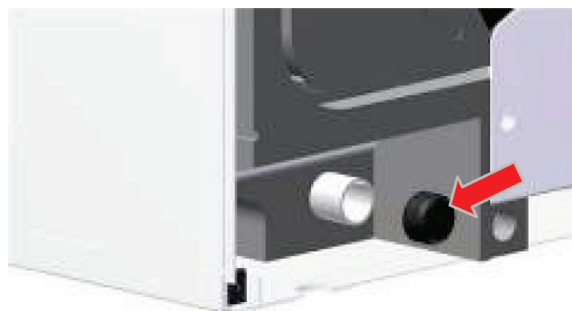
Obr. 10: Odstranění záslepky z vývodu kondenzátu (zadní strana)
