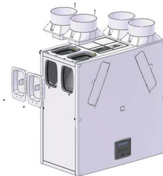
Obr. 18: Demontáž a instalace hrdel
