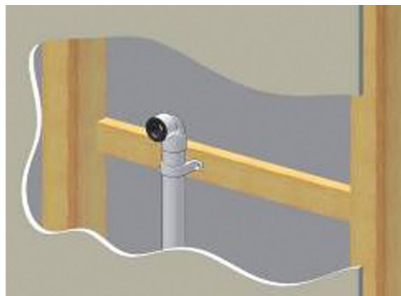
Obr. 15: Příprava připojení odvodu kondenzátu na svislý odpad
