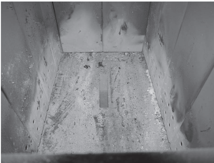
Obr. 6 Správne vyčistená nakladacia komora
