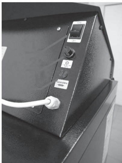
Obr. 17 1 – hlavný vypínač, 2 – havarijný termostat, 3 – poistka (F6,3A)
