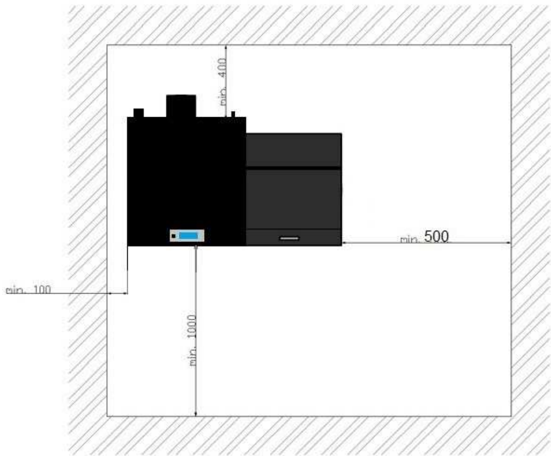
Obr. č. 12 - Umístění kotle
