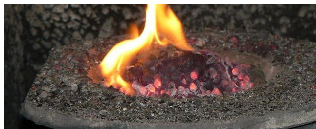
Obr. 5. Poloha pelet na retortovém hořáku během provozu kotle.
